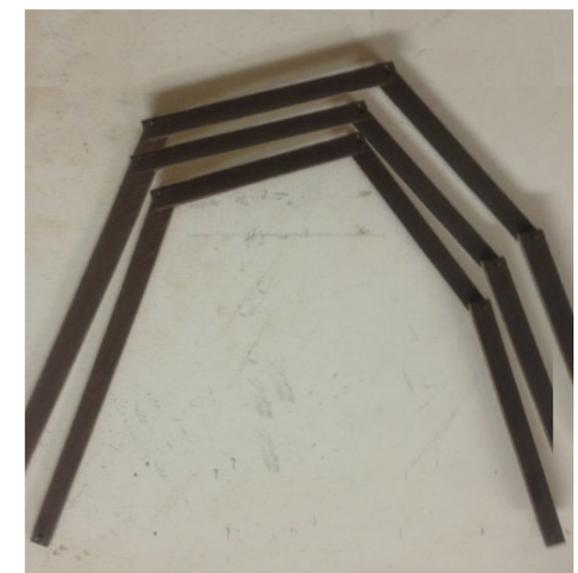
Génération d'une Structure antifuniculaire par succession de "Cadres" conçus sur le même principe.
